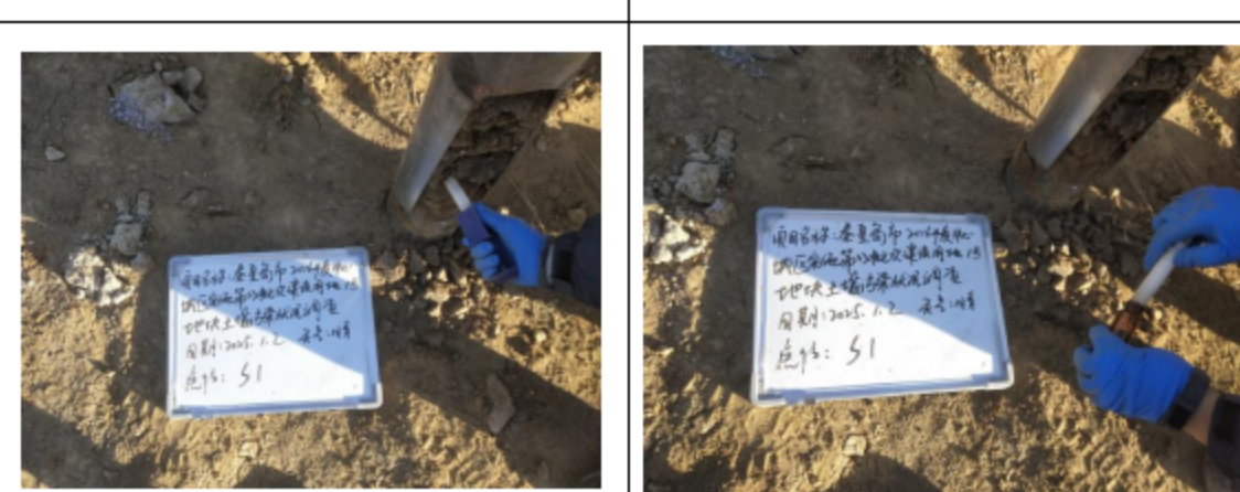
套管跟进、VOCs 取样照片
