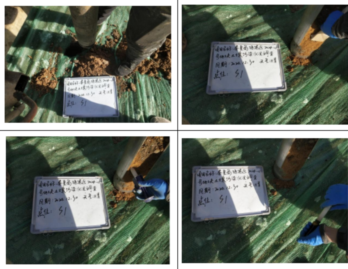
套管跟进、VOCs 取样照片
