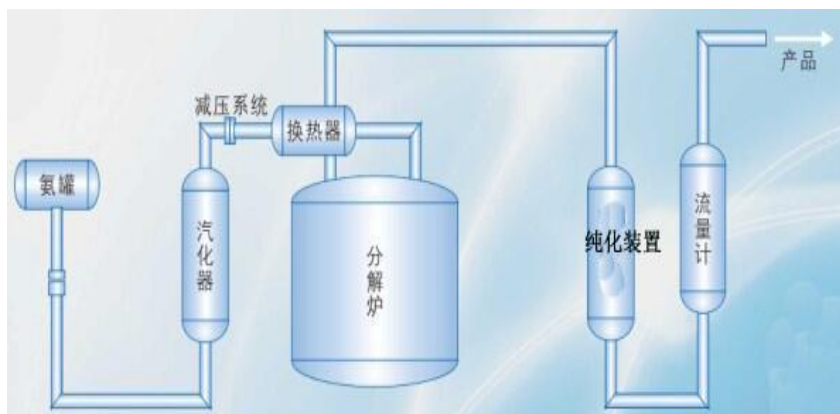
图 4-4 液氨分解工艺流程图
