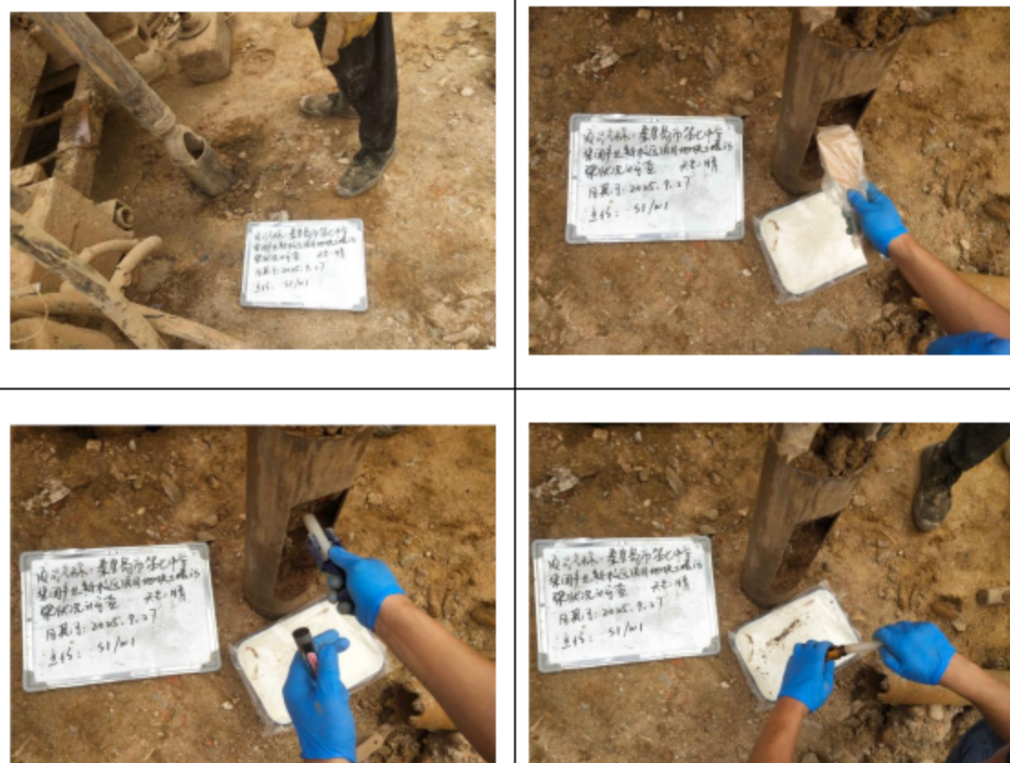
套管跟进、VOCs 取样照片
