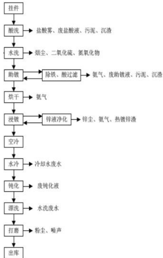
图 4-3 镀锌工艺流程及排污节点
