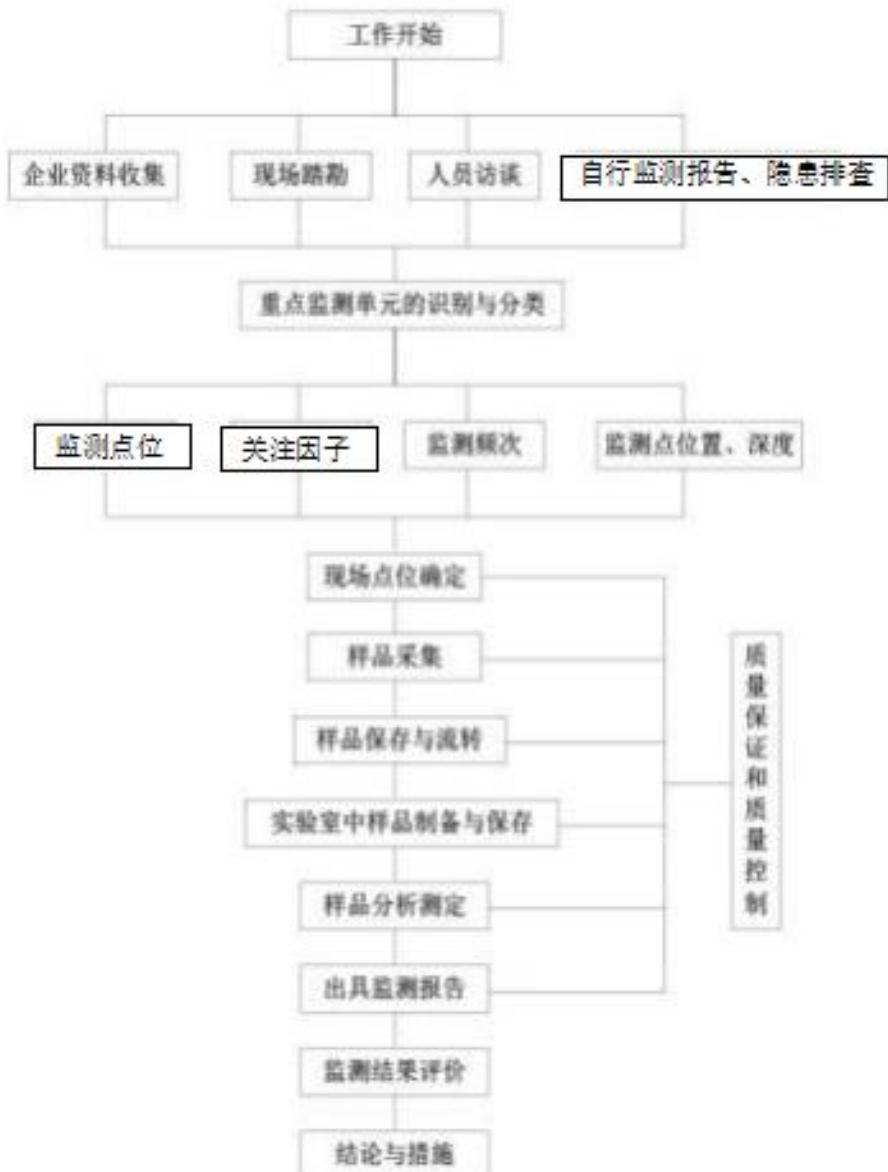
图1-1 布点、样品采集、保存和流转工作程序流程图
